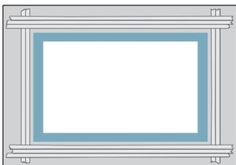
Contrôle : Allumer le projecteur. La distance entre l'écran éclairé et le ruban adhésif doit être de 5 cm exactement (si vous avez la boîte MPW 20) ou de 7 cm exactement (si vous utilisez la boîte MPW 30) ! (voir illustration). Éteindre à nouveau le projecteur.
